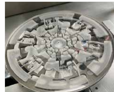
光碟式微流道快篩晶片 - 小分子內分泌定量檢測
