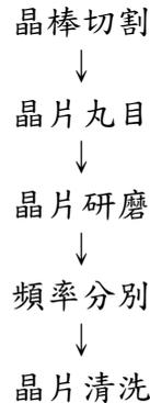
晶棒依設計需要以不同切割角度切成晶片，晶片再依不同規格以機械加工成圓形或長條型。成型後之晶片，經粗研磨、中研磨再精研磨達成預定設計之頻率範圍，經由自動頻率檢測機分別選出各種設計規格內之晶片，加以清洗後入庫。
